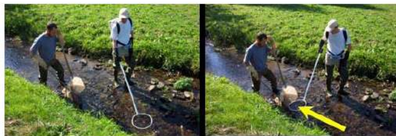
Figure 2. Réalisation d'un trait d'électrode d'environ 2 mètres par l'opérateur. Photo de gauche : juste avant immersion de l'électrode ; photo de droite : le trait s'arrête devant l'ouverture de la grande époussette maintenu contre le fond par le pêcheur. A noter, le pêcheur tient également en main droite une époussette maniable pour récupérer les poissons à vue.
